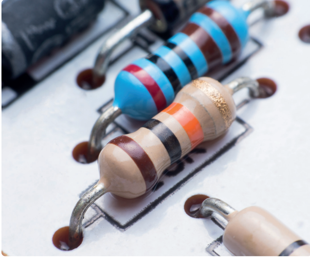
شكل 2.1: صورة حقيقية للمقاومة
