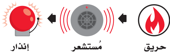
شكل 5.2: نظام إنذار الحريق
