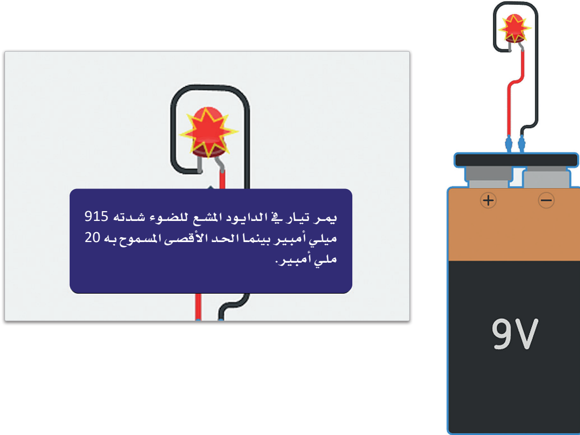
شكل 4.21: محاكاة مع وجود مشكلة في التيار في الدائرة
