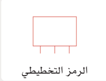
شكل 3.4: مُستشعر درجة الحرارة TMP36
