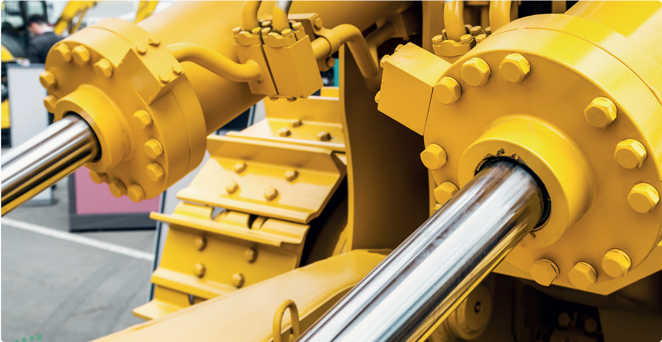
شكل 1.15: نظام مُشغِّل هيدروليكي (مكبس) للآلات الثقيلة
