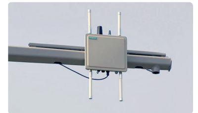
شكل 7.6: وحدة الاتصال على جانب الطريق (RSU)
