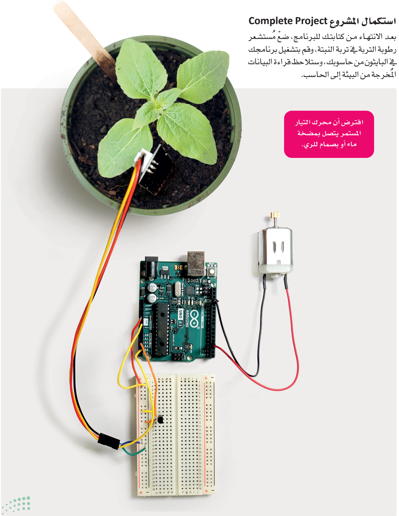
شكل 4.30: الحديقة الذكية باستخدام الأردوينو
