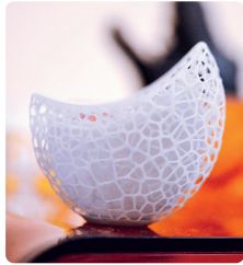
شكل 3.2: مجسم مطبوع بالبوليمرات الضوئية بواسطة طابعة ثلاثية الأبعاد
