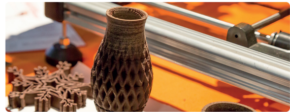
شكل 3.12: الطباعة ثلاثية الأبعاد بمادة السيراميك
