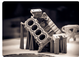
شكل 3.4: مجسم مطبوع بواسطة آلة تليد بالليزر
