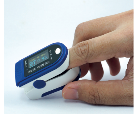
الشكل "3-58" يُستخدم مقياس التأكسج النبضي لقياس مستوى الأكسجين في الدم الشرياني.
