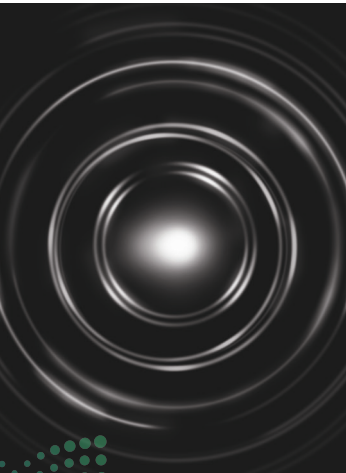
■ الشكل 6-8 تظهر أنماط حيود الإلكترونات - كهذا النمط الخاص ببلورة زركونيوم مكعبة - الخصائص الموجية للجسيمات.
