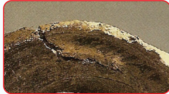
شكل (١٠٦): يوضح نتائج أخطاء التجفيف ( تشقق ).
